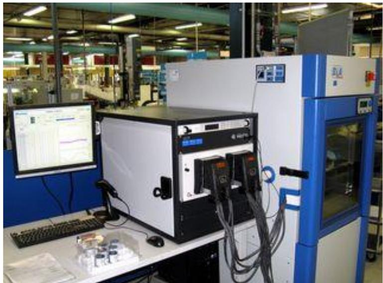
Figure 1. La baie 19" contenant le châssis PXI, les deux interfaces de connexion et l'étuve
